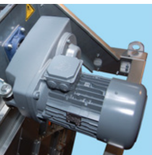
Напрямую смонтированный мотор-редуктор с опорной рамой.
